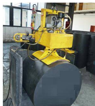
圆弧形真空吸盘吊具(额定载荷1000kg)
