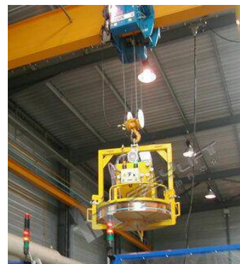
卷材真空吸盘吊具(额定载荷2000kg)
