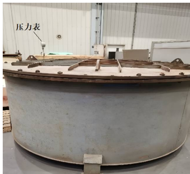
低压氮气密闭保护运输容器
